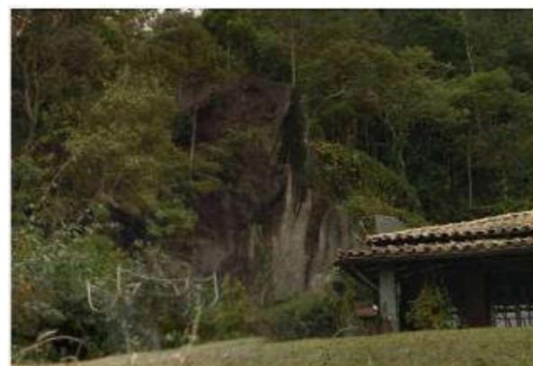
Foto 062 – Moradia construída em local de depósito de blocos rochosos.
