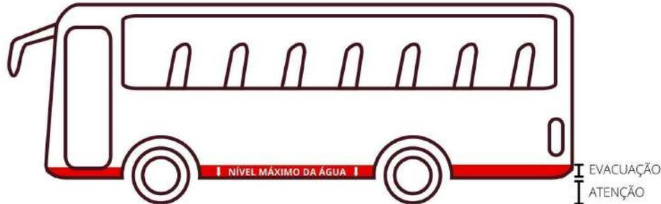
Figura 39: Modelo de faixa a ser adotado em todos os ônibus, indicando a necessidade de evacuação.
